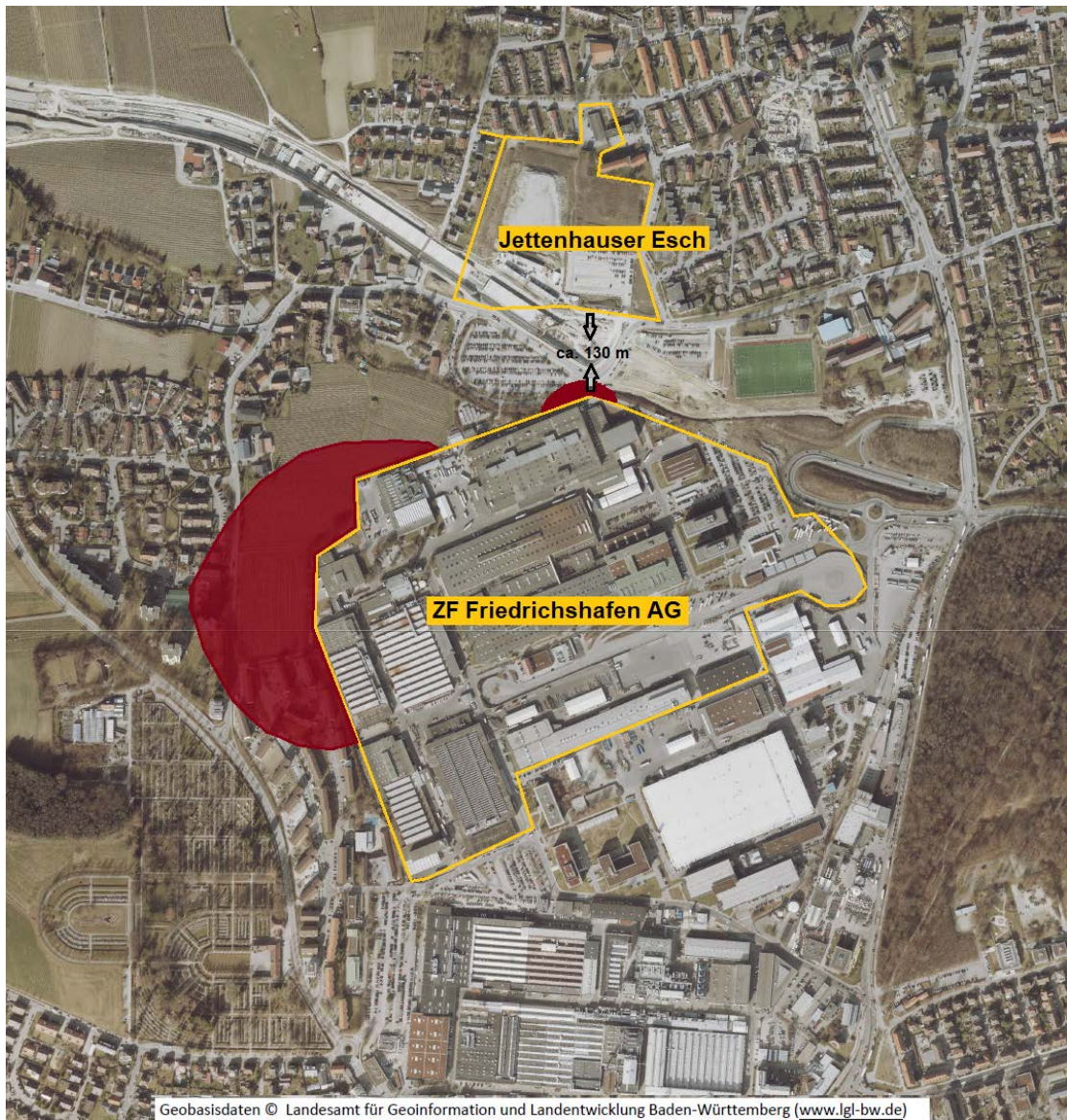
Abb. 4.6: Angemessener Sicherheitsabstand um das Werksgelände ZF (Nördliche Richtung)
