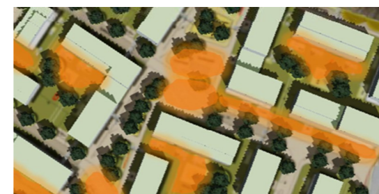
Identifikation von Hitzequellen im 3D-Modell
