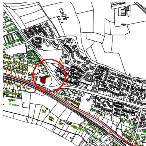
Abbildung 15: Ausschnitt aus der Lärmkarte nach RLS-90 LK2 für den Zeitbereich Nacht (Lärmaktionsplan Stufe 3)
