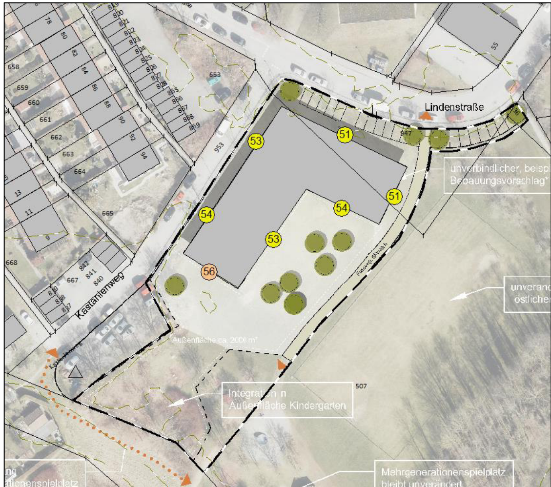
Abbildung 6: Fassadenpegel für den Tagzeitraum (ohne Maßstab) eigene Darstellung; Quellen: Katastergrundlage: Geobasisdaten © 2019 Landesamt für Geoinformation und Landentwicklung Baden-Württemberg (www.lgl-bw.de) [1], Rahmenplan Stadt Friedrichshafen [4]
