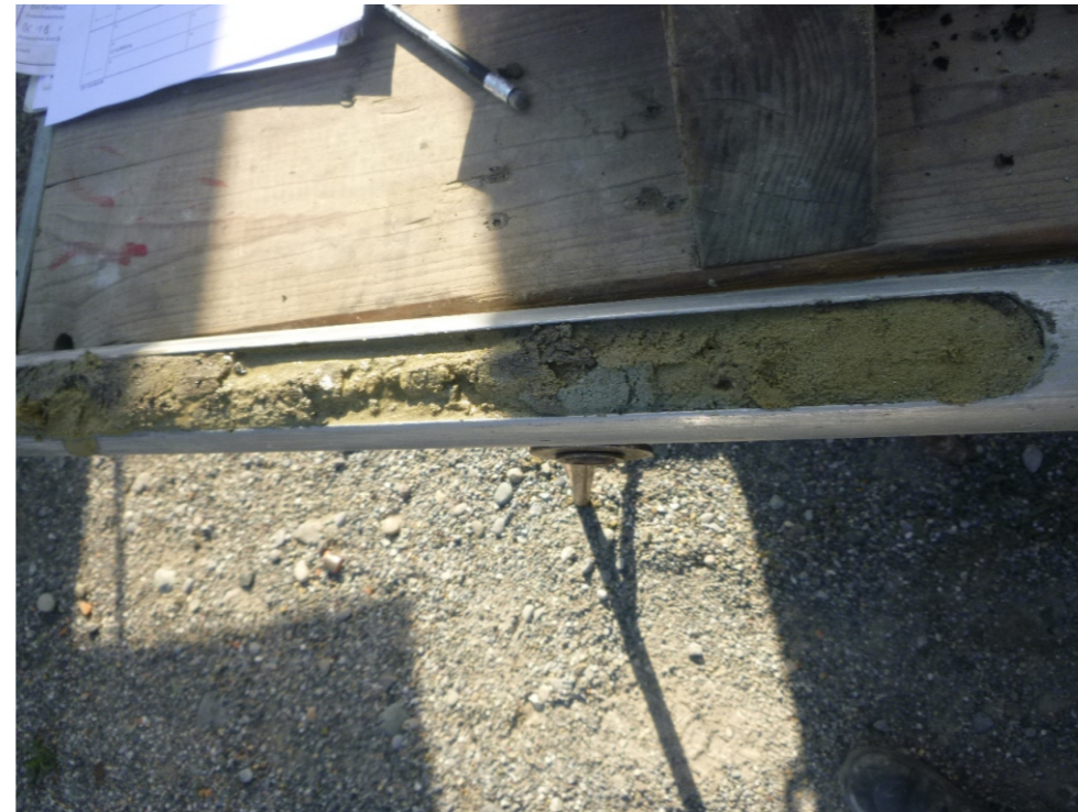
Bild 5: Bohrkern aus BS 3: Übergang grundwasserungesättigte/ -gesättigte Bodenzone in den Terrassensanden (2,2 m Tiefe u. Gel.).
