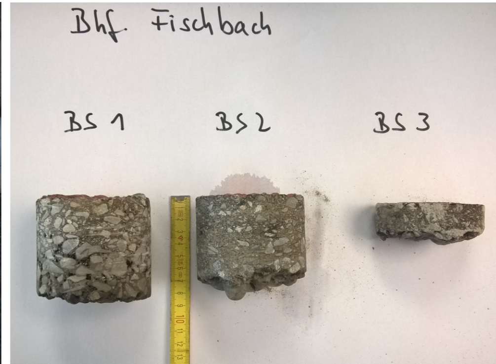
Bild 6: Schwarzdeckenbohrkerne (ohne durchörterten - an BS 3 bitumen-gebundenen - Grobkies dargestellt) aus BS 1, BS 2 und BS 3.
