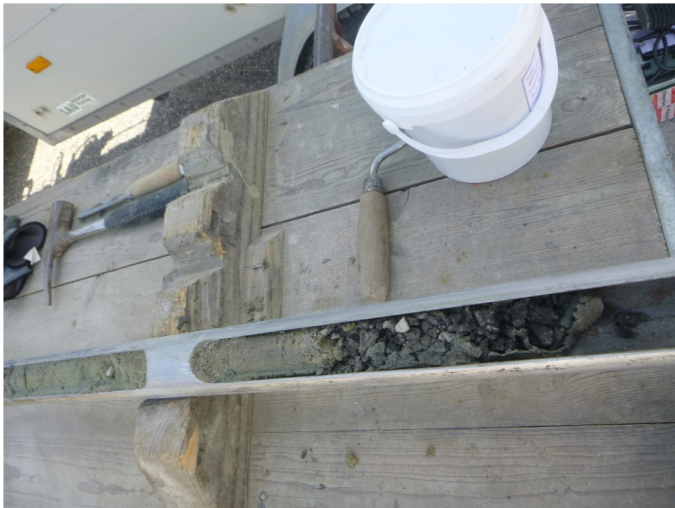
Bild 4: Bohrkern aus BS 1: Übergang vom Paläoboden (dunkler Horizont) zu den Terrassensanden (olivgrau).
