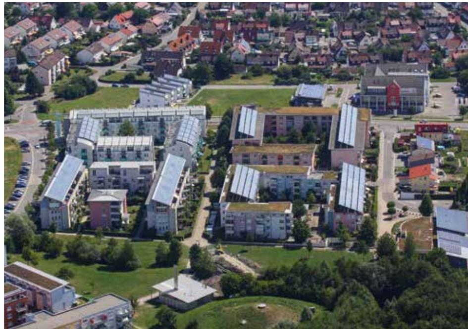
Am unteren Bildrand sind der begrünte Langzeitwärmespeicher und die Heizzentrale der Solarsiedlung Wiggenshausen zu erkennen. Die von den Sonnenkollektoren aufgenommene Wärme wird mittels Wärmetauscher an den Langzeitspeicher abgegeben, der die Siedlung von April bis Oktober mit Warmwasser und Heizungswärme versorgt. Im Winter übernimmt eine Gasheizung die Nahwärmeversorgung.
